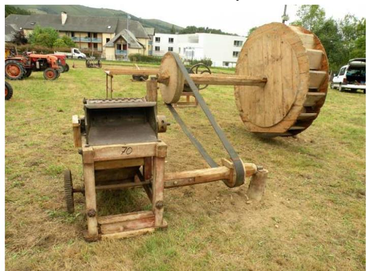
Batteuse actionnée par la force de l'eau via une roue à aube.
