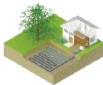
Pompe à chaleur sur capteurs enterrés horizontaux
